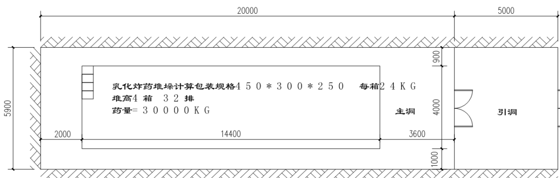
图 2.3-2 2#工业炸药库存药堆垛平面示意图
