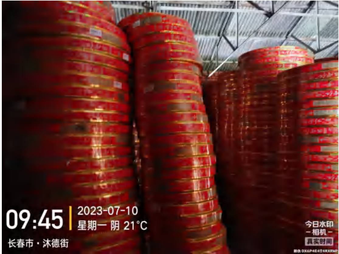
整改前：3#仓库 1 处产品堆垛倾斜严重
